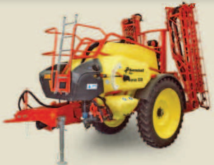
Ikarus S38 s HC 24m vertikálně sklopnými ocelovými rameny
